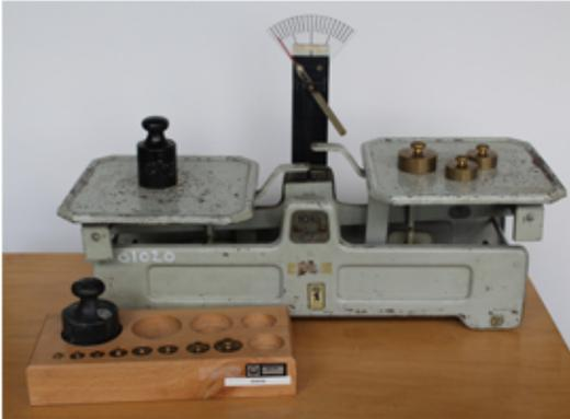
*Das ist eine Tafelwaage, ein Gerät mit dem man Gegenstände wiegen kann. Sie hat zwei Schalen. Der Zeiger in der Mitte zeigt an, ob die Schalen im Gleichgewicht sind. Um einen Gegenstand zu wiegen, stellt man ihn z. B. auf die linke Schale. In die rechte Schale stellt man Gewichte, deren Masse bekannt ist. Das macht man so lange, bis beide Schalen im Gleichgewicht sind. Die Masse des Gegenstands entspricht der Summe aller Gewichte.*
