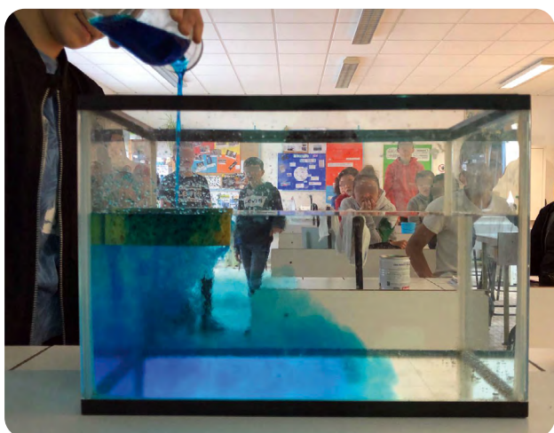
Das kalte Wasser sinkt auf den Boden des Behälters.
